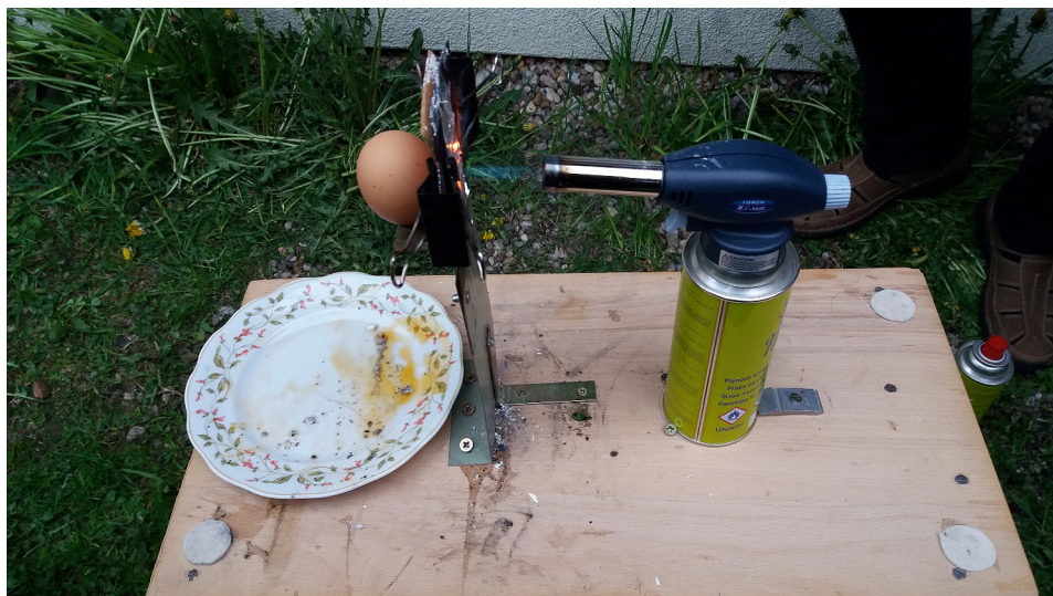
Ryc. 3. Ćwiczenie: oddziaływanie temperatury na osłonę ablacyjną podczas przejścia obiektu przez ziemską atmosferę Źródło: Sypniewski (2017).
